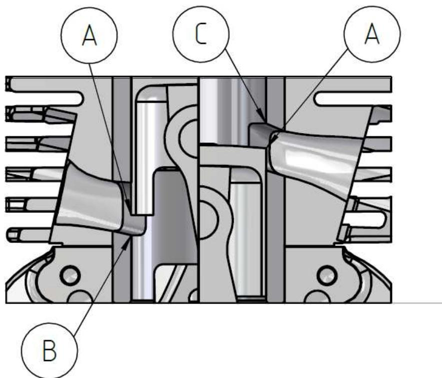
Afin de rendre la mesure plus précise, la "cale d'angle d'ouverture", une cale de 5 mm de large et de 0,20 mm d'épaisseur (voir DT n°1.4), doit être utilisée pour établir le début et la fin de la mesure.
