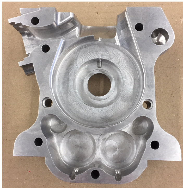
Photo de l'intérieur du carter droit / Photo of the inside of the right crankcase
